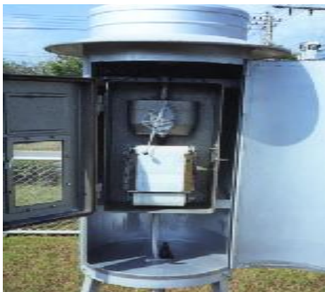
เครื่องวัดฝนแบบจดบันทึก (Rainfall Recorders)
