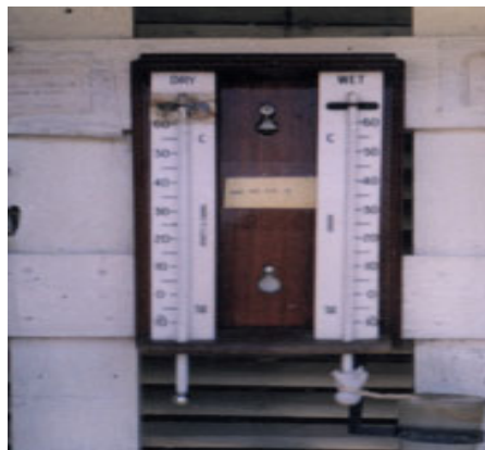
เครื่องมือวัดอุณหภูมิของอากาศ (Dry-Wet Bulbs psychrometer)
