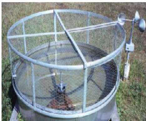
เครื่องวัดน้ำระเหยแบบลาด (American Class A Pan)
