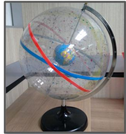
เครื่องมือระบุตำแหน่งในระบบพิกัดขอบฟ้า แบบจำลองทรงกลมท้องฟ้าแสดงตำแหน่งดาว
