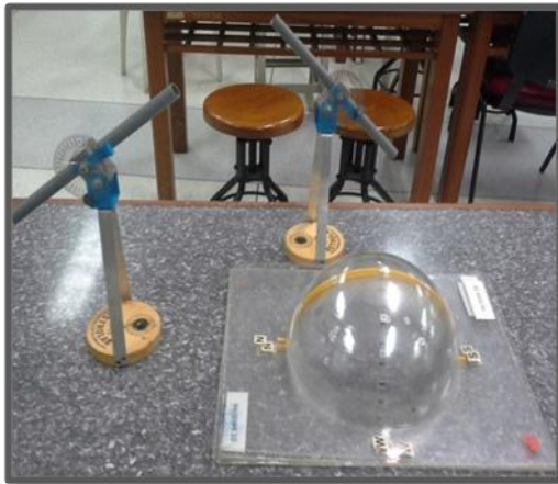
เครื่องมือระบุตำแหน่งในระบบพิกัดขอบฟ้า แบบจำลองทรงกลมท้องฟ้าแสดงตำแหน่งดาว
