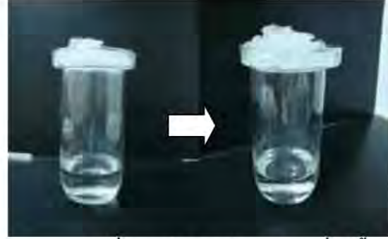
ภาพการเปลี่ยนแปลงภายในภาชนะที่ใส่น้ำเย็น เมื่อวางภาชนะบนที่ใส่น้ำแข็งบนปากภาชนะ
