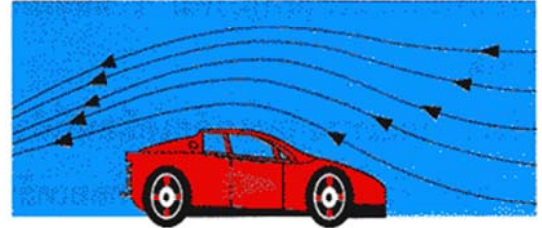
รูป 9.32 การไหลอย่างสม่ำเสมอของอากาศผ่านรถยนต์ทดลองในอุโมงค์ลม
