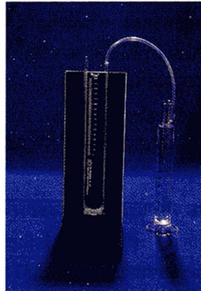
รูป 9.43 การวัดความดันในของเหลวโดยใช้แมนอมิเตอร์
