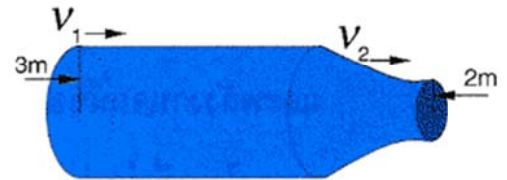
รูป 9.36 การไหลของน้ำในท่อ
