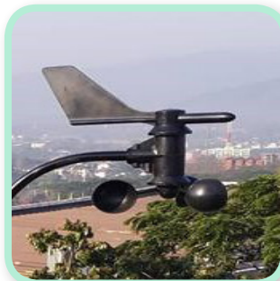
แอนนิโมมิเตอร์วัดความเร็วและทิศทางลม
